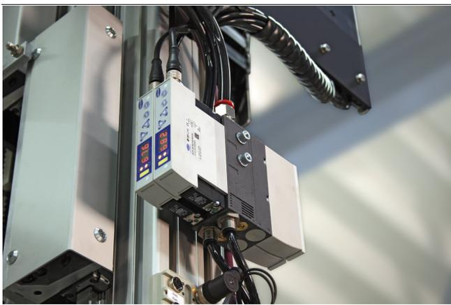
Zentrale Vakuum-Erzeugung durch Kompaktejektoren SMPi
